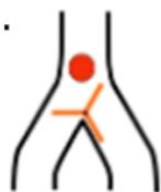
Kad kuglica dođe do usmjerivača, spusti se dalje u cijev, a usmjerivači se okrenu, tako da sljedeća kuglica ide u drugu cijev.
